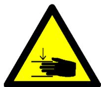
Achten Sie bei der Montage, Demontage und bei Einstellungsarbeiten auf die Quetschgefahr zwischen beweglichen Teilen Ihres Gerätes.
