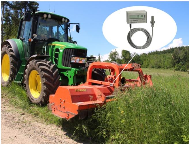
Der Betriebsstundenzähler für Maschinen mit Zapfwellenantrieb oder rotierenden Teilen
