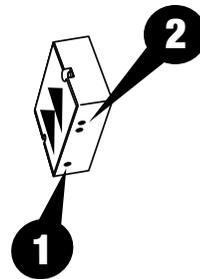
Von 1 nach 2 bedeutet, dass zuerst die Seite mit 1 LED, dann die mit 2 LED getriggert wird und umgekehrt.
