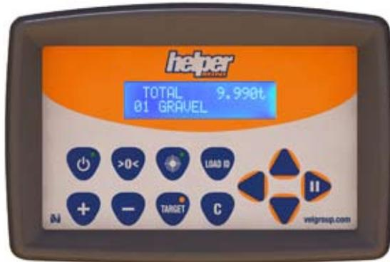
Die **helper mini** ist eine dynamische Waage, die das Gewicht anhand des Hydraulikdrucks im Hubzylinder ermittelt; je höher der erforderliche Druck zum Heben ist, desto größer das Gewicht.
