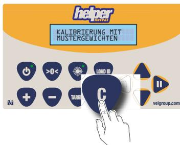
Überprüfen Sie nun mit einigen Testwägungen, ob die Justage gut genug ist (maximal 1-2 Teilungswerte Abweichung pro Schaufel, eher weniger) und heben Sie bei unterschiedlichen Geschwindigkeiten. Verändern Sie gegebenenfalls einzelne Kalibrierfaktoren (Kapitel 14 und 15).
