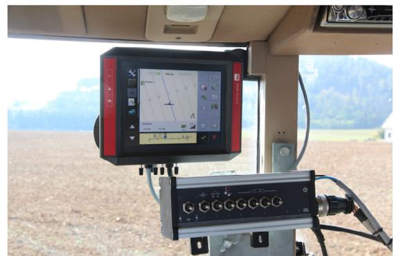
Abb. 2: Spritzenbedienung und Teilbreitenschaltung über Müller-Elektronik TRACK-Guide III
